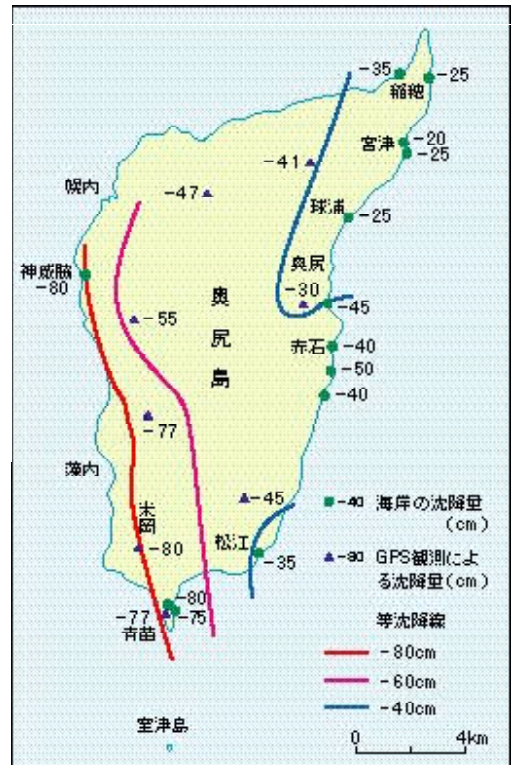
図3-16 北海道南西沖地震による奥尻島の上下変動奥尻島の西岸は少なくとも80cm、東岸は20~50cm程度沈降した。[国土地理院地(1993)]
