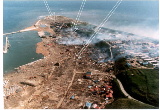
図3-16 北海道南西沖地震による奥尻島の上下変動奥尻島の西岸は少なくとも80cm、東岸は20~50cm程度沈降した。[国土地理院地(1993)]
