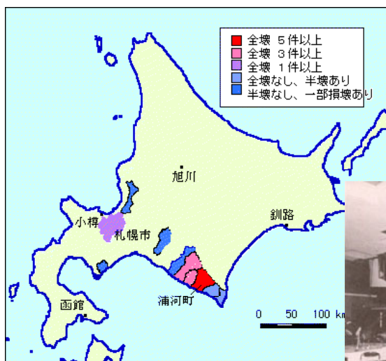
図3-21 浦河沖地震の建築物などの被害概要〔東京(1983)から作成〕
